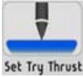
사용자는 샘플조직의 최적화된 삽입을 위한 Recipient Block hole 에서의 puncher 깊이를 설정 할 수 있습니다. 값이 변경 될 때마다, 사용자는 '설정'버튼을 클릭해야 합니다. 그렇지 않으면, 변경된 설정 값이 적용되지 않습니다.
